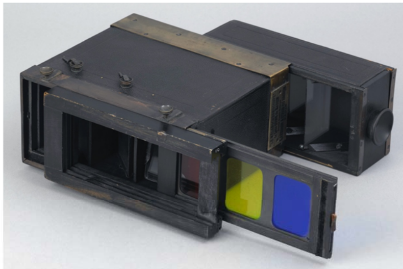
Mélanochromoscope de Louis Ducos du Hauron, inventeur de la photographie en couleur.
